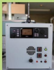
災害時に基地局が使用できない場合に使用する無線機です。指令回線切断時には無線による指令受信を行います。
