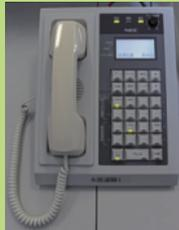
無線回線制御装置と接続し、車載型無線装置および携帯型無線装置と通信を行う設備です。高機能指令設備輻輳時の無線統制等に使用します。
