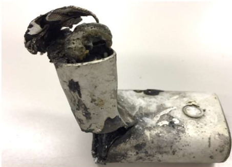
発火原因となった加熱式たばこ (リチウムイオン電池内蔵)
