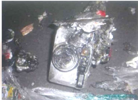
発火原因となったデジタルカメラ (リチウムイオン電池内蔵)
